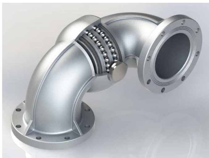
Шарнир серии 0878: алюминиевый двурядный, состоит из 2-х частей с поворотными коленями и фланцами тип ТТМА.
